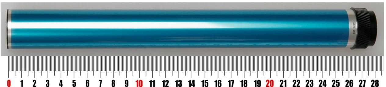
3. Покрытие на барабане прозрачное (свет отражается от алюминиевой поверхности барабана), это покрытие имеет при обычном освещении сине-зеленые оттенки. Общая длина барабана 277 мм.
